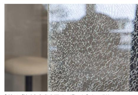
$\textbf{Geh\"{a}rtetes Sicherheitsglas} \text{ f\"{u}r die W\"{a}nde und T\"{u}ren der Treehouse-Kabinen}$
